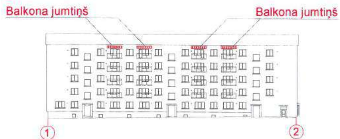
Balkonu jumtiņu izvietojuma shēma
